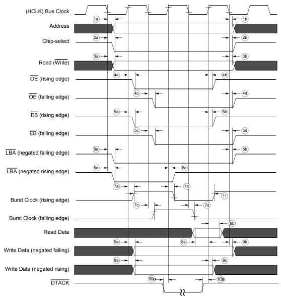
Figure 53. EIM Bus Timing Diagram
